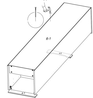
4. Установка опор-наконечников и передней стенки опоры
